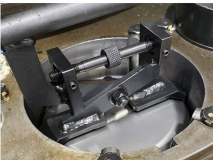
アッパータレットより金型を挿入します。
